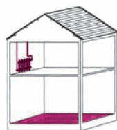
Une zone radiateurs et une zone plancher chauffant avec ISO FLOOR
