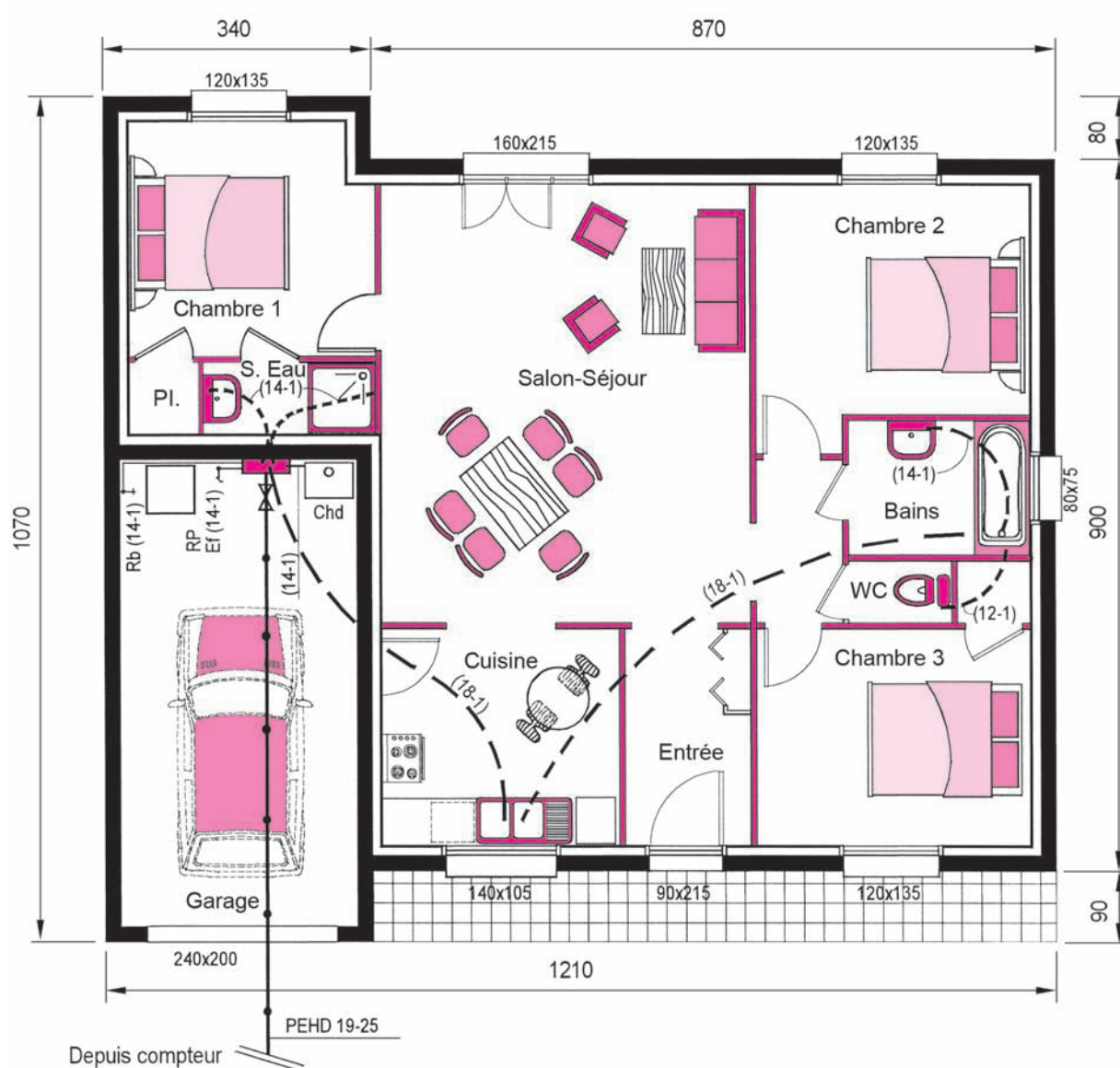
Fig. 43 : Canalisation d'amenée en PEHD et distribution d'eau froide en enrobé et en apparent
