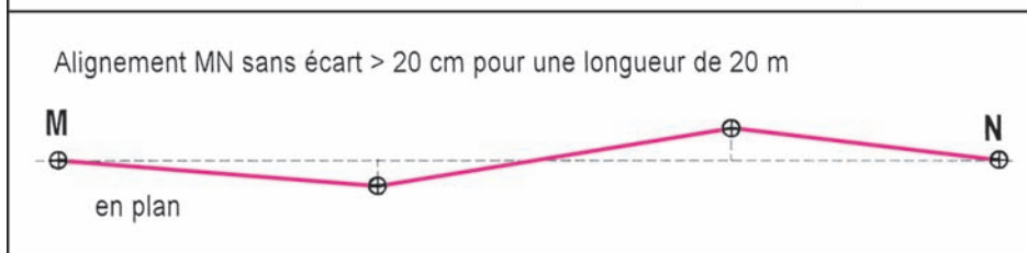
Fig. 11 : Mesures à effectuer sans excès de défaut d'alignement et d'horizontalité
